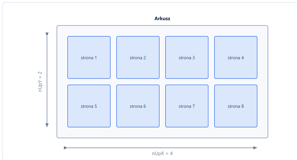
Rys. Układ N-up: nUpX \times nUpY stron na stronie arkusza.
