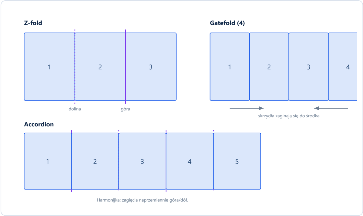
Rys. Schematy falcowania: Z-fold, gatefold 4-panelowy, harmonijka (linie zagięć).
