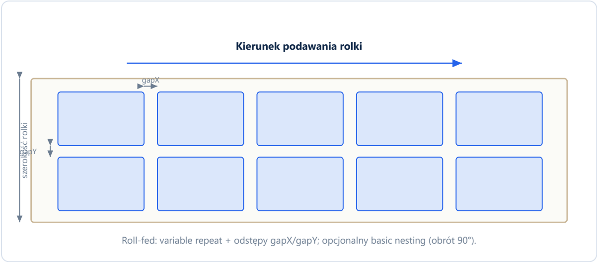
Rys. Roll-fed step-and-repeat na rolce ciągłej.
